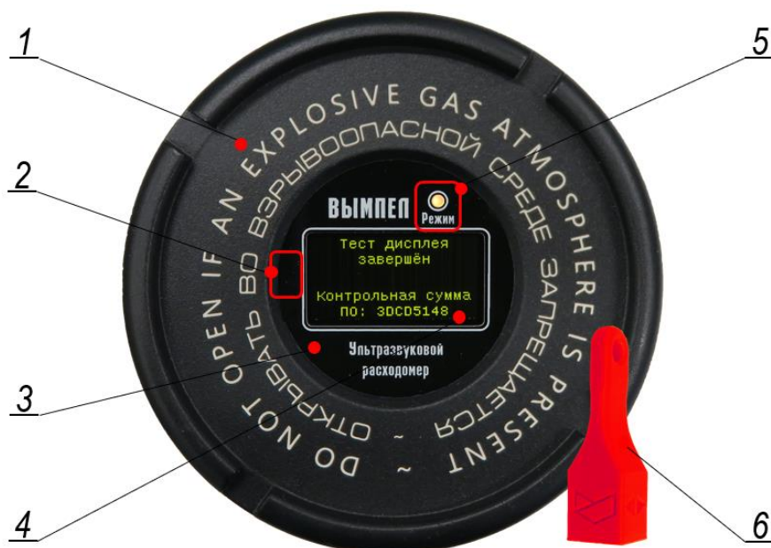
1 – крышка БЭР; 2 – зона активации магниточувствительного датчика; 3 – индикатор БЭР/ БЭР-ВР; 4 – ЖКД; 5 – СИР; 6 – магнитный ключ
