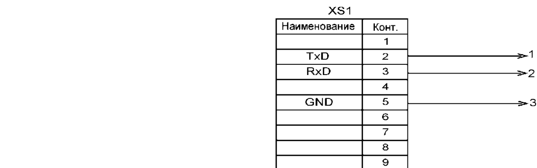
Рисунок И.1 – Схема кабеля КРАУ4.841.020 для подключения компьютера к БИЗ-002
