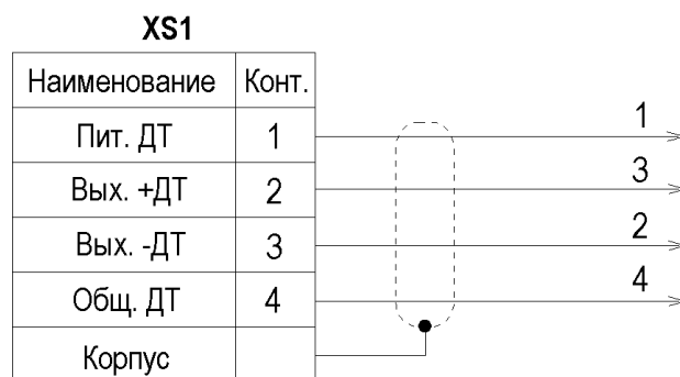
Рисунок Б.7 - Кабель КРАУ4.853.820 для подключения термометра сопротивлений к прибору «ГиперФлоу-3Пм»
